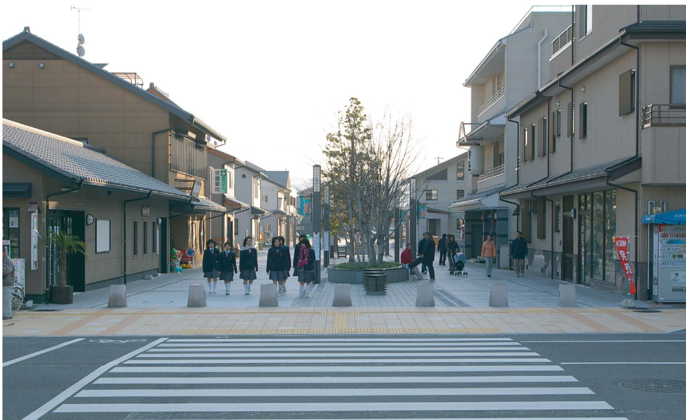
▲「おび通り」の沿道建物は、地区計画に基づき、壁面線の位置をセットバックして揃えている。
