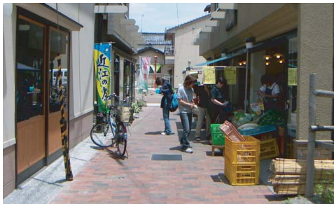
▲賑わいの創出を目的に、区画整理事業の換地計画で幅3mの路地空間を確保。両側に店舗が向かい合うように誘導している。
